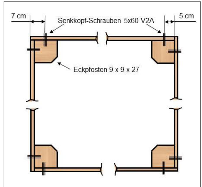
Abb. 5: Die Seitenbretter müssen wie hier dargestellt überlappend montiert werden.
