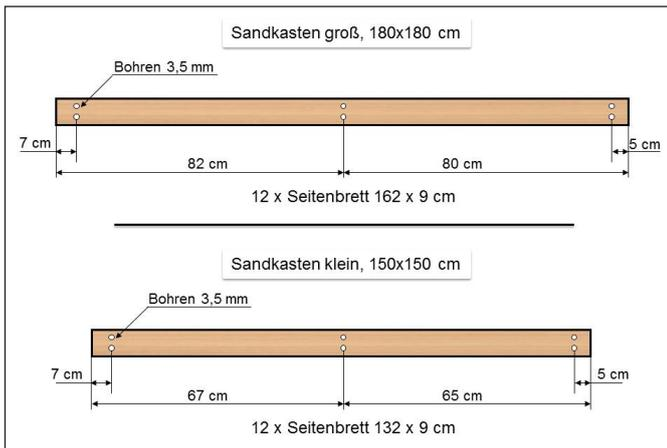
Abb. 3: Die Seitenbretter sind entsprechend der Maßangaben mit einem 3,5 mm Bohrer vorzubohren.
