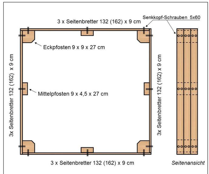
Abb. 6: Abmessungen des fertig aufgebauten Sandkastenrahmens.
