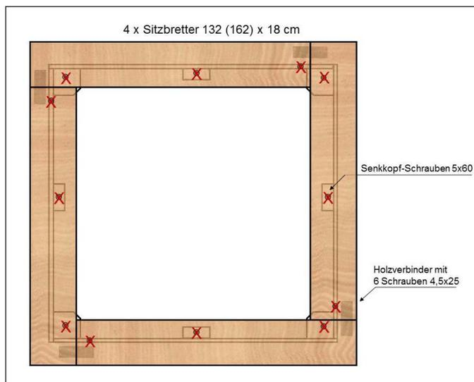
Abb. 8: Der fertig montierte Sandkasten, mit Sitzbrettern und Holzverbindern. Vor dem Verbohren und Verschrauben sollte der Sitzrahmen mittig auf dem Rahmen aufgelegt werden. Maße für Sandkasten 180 x 180 cm in Klammern.
